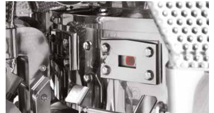
Contrôle de la benne de ravitaillement par cellule photoélectrique
