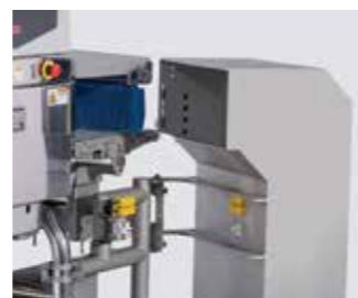
La conception des bacs de protection et de rejet permet un accès facile.
