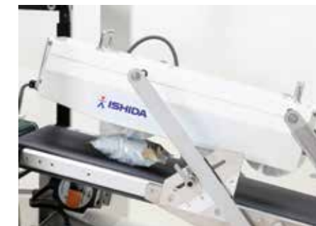
Une variété de convoyeurs d'entrée peuvent être fournis pour amener les paquets de la machine à sacs dans le testeur d'étanchéité TSC.
