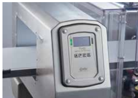
Détection des métaux : des unités multi-fréquences et multi-spectres peuvent être intégrées.
