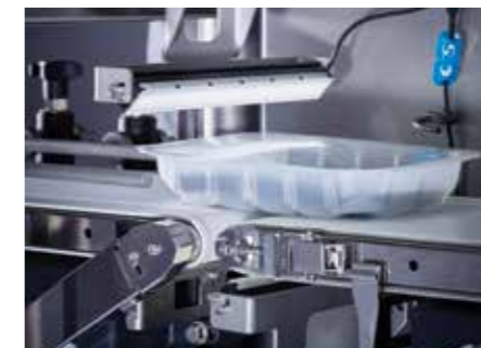
Pour un contrôle intégral des étiquettes d'emballage, un système de lecture peut être monté sur la plate-forme QC220.
