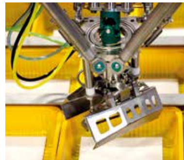
La conception unique de la pince permet une orientation et un positionnement ultra-rapides des pièces
