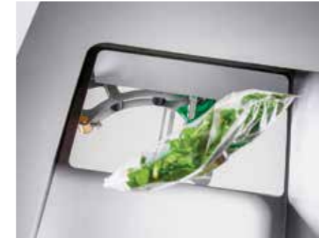
Standard Auswurf durch eine Luftdüse
