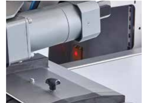
Sensoren für Behälter-voll-Anzeige und Ausschleusebestätigung
