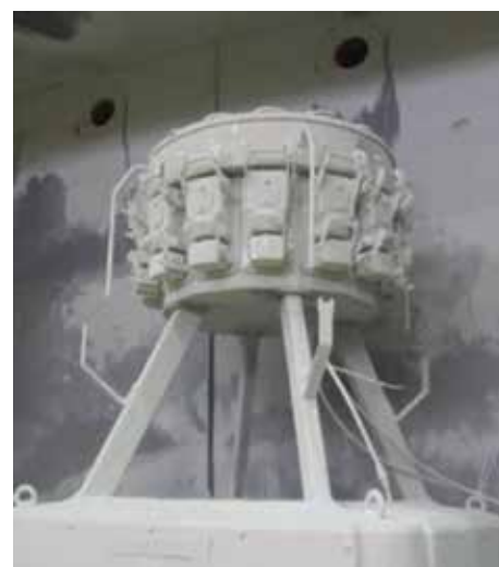
Badanie ochrony przed pyłem IP6X
