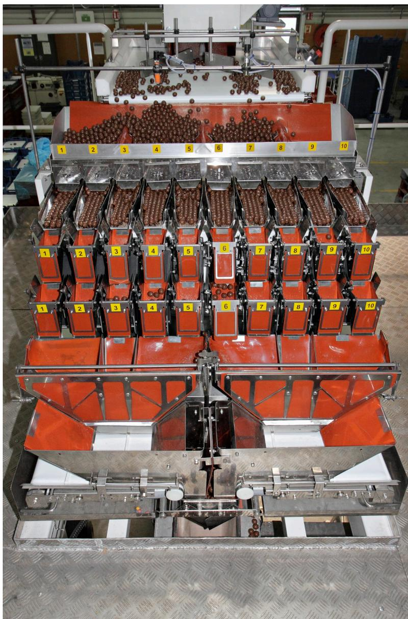
▲ Интегрированный в производственную линию Corperia, новый весовой дозатор Ishida с его плавными скатами и специальной ударопоглощающей поверхностью обеспечивает 99,5% сохранность продукта при взвешивании и упаковке
