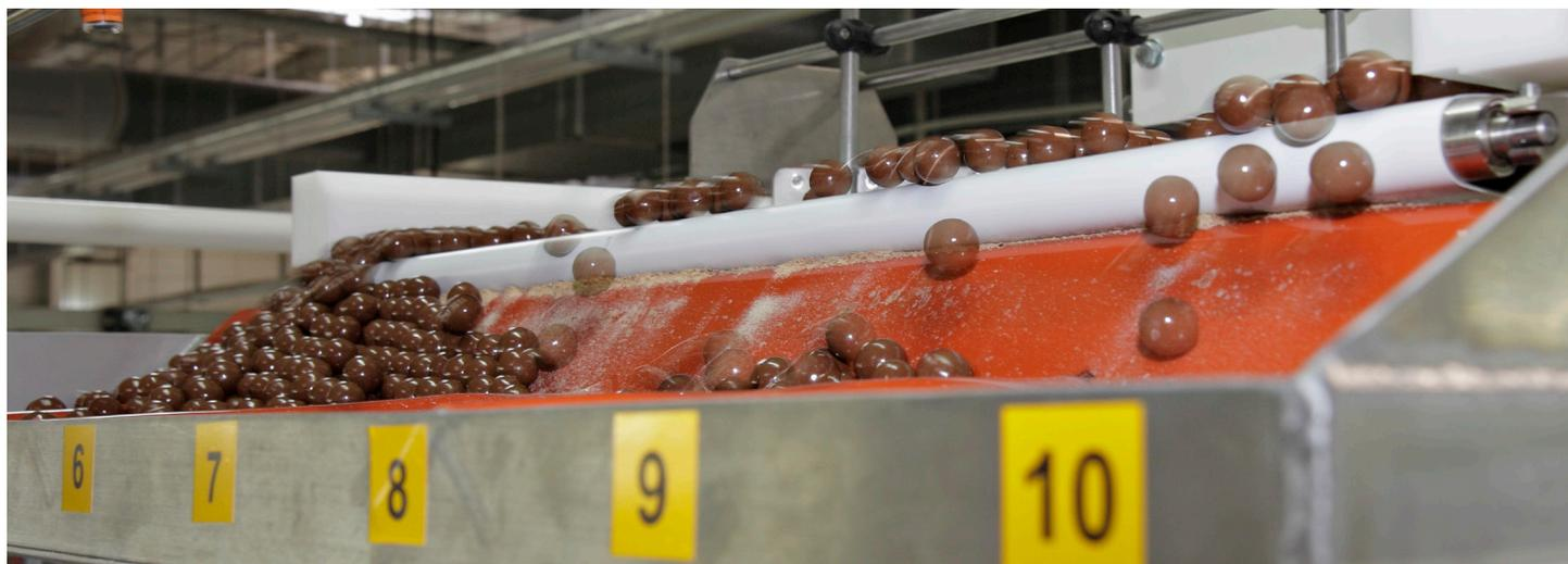
Команда инженеров компании Ishida провела всестороннее тестирование продуктов, выпускаемых на фабрике Corperia, экспериментируя с различными весовыми дозаторами и высотой падения продукта на ленту. Решением проблемы оказалось использование мультиголовочного весового дозатора с однорядной установкой весовых бункеров при минимизации высоты падения и обеспечения мягкого контакта продукта с лентой из ударопоглощающего материала.
