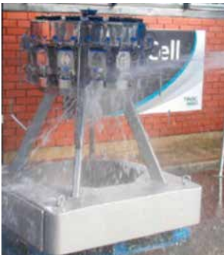
Fortlaufender Test mit starkem Strahlwasser für IPX6
