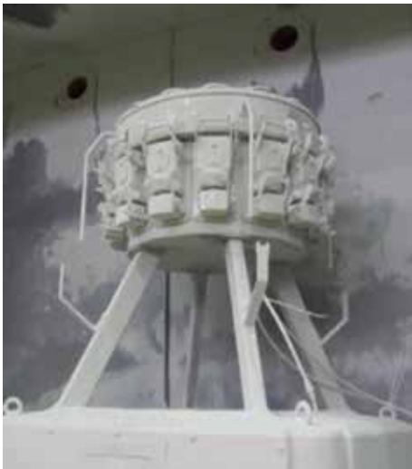
Staubprüfung für IP6X
