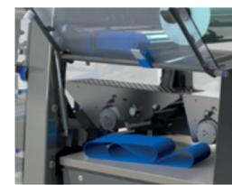
Быстрота перенастройки на новый тип продукта и мойка оборудования. Автоматический и быстрый демонтаж всех съемных частей и конструктивные особенности, обеспечивающие самодренаж, гарантируют простоту чистки и перенастройки оборудования на новый тип продукта.
