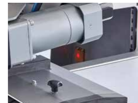
Czujniki wypełnienia zbiornika i potwierdzenia odrzutu
