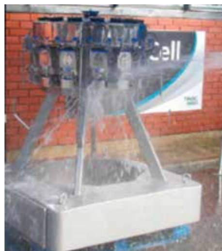
Испытание герметичности водяной струей под большим давлением в соответствии с классом защиты IPX6
