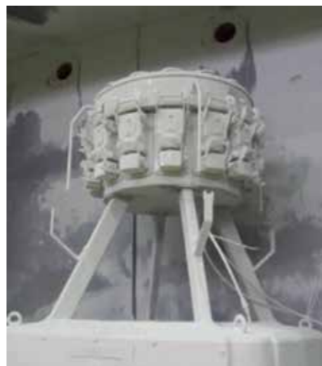
Испытания пыленепроницаемости в соответствии с классом защиты IP6X
