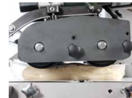
Compressione per espellere l'atmosfera modificata
