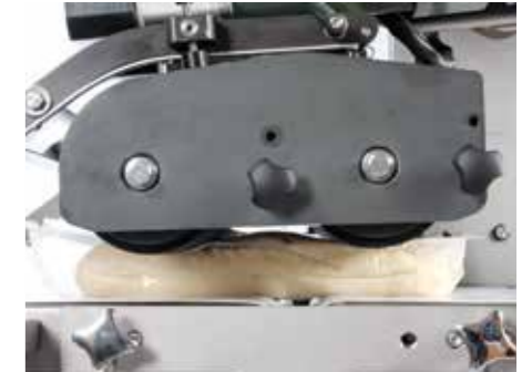
Verpackungs-Kompression zum Ausstoß von MAP
