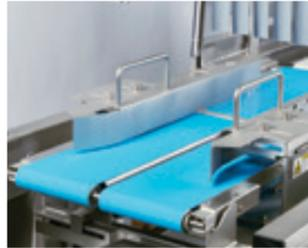
Convoyeur séquenceur à guidages d'alimentation motorisés
