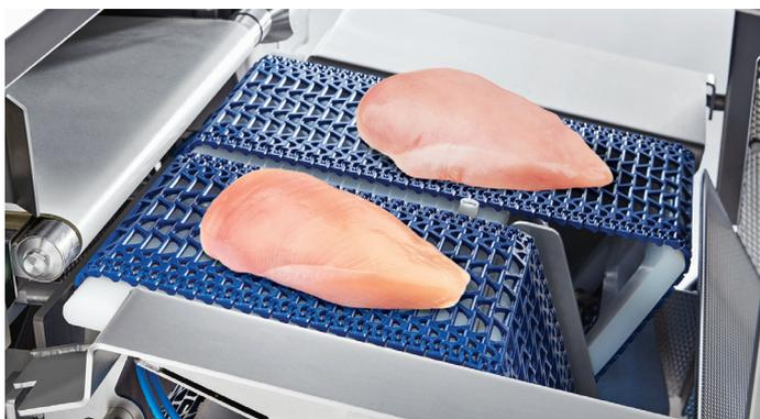
Высокоскоростная двухконвейерная система отбраковки
