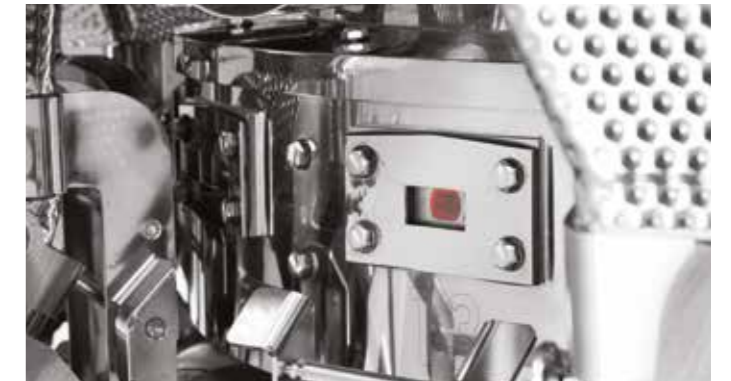
Контроль наполнения накопительных бункеров фотодатчиком
