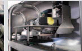
Машина для проверки качества запайки пакетов Ishida TSC-RS для надежного определения соответствия обнаружения мест нарушения герметичности упаковки
